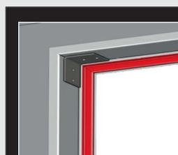
Joint d'étanchéité EPDM sur dormant
