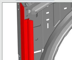
Joint à lèvre EPDM sur rails verticaux
